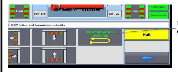
Nach der Umschaltung wird die Betriebsart durch die grüne Tastenschrift signalisiert.
