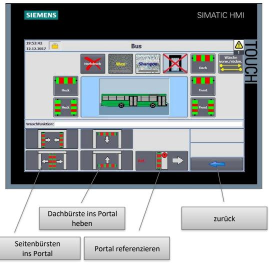
Rot blinkende! – Zeichen zeigen an, dass diese Antriebe in Grundstellung gefahren werden müssen.
